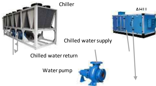
Gambar 5. 4 Instalasi dari Chilled Water System
