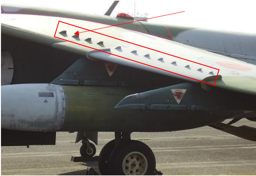
Gambar 1.2 Vortex generator pada sebuah sayap pesawat udara (Sumber: https://phys.org/news/2012-09-scientists-purpose-vortex.html )
