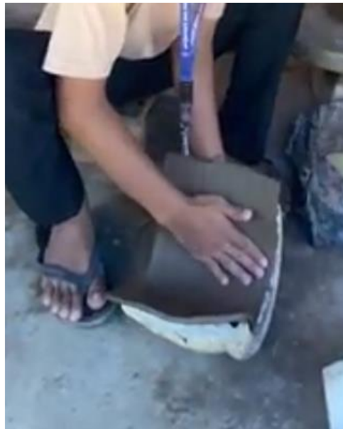
Gambar 8. Proses pencetakan dengan menekan tanah liat sesuai dengan cetakan Sumber: Dokumentasi Penulis
