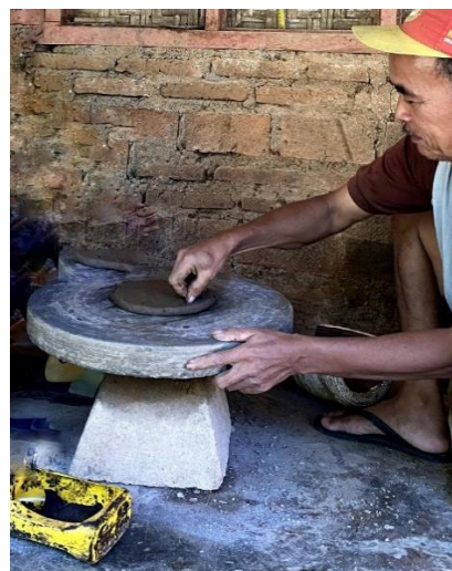
Gambar 6. Proses pembuatan dasar bawah pot gerabah Sumber: Dokumentasi Penulis
