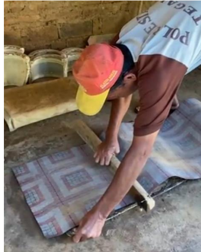
Gambar 7. Proses pemotongan tanah menggunakan glayer Sumber: Dokumentasi Penulis
