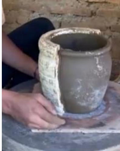
Gambar 11. Proses menyatukan cetakan menggunakan karet Sumber: Dokumentasi Penulis
