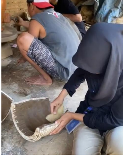
Gambar 9. Proses merapikan tanah liat menggunakan plastik flat Sumber: Dokumentasi Penulis
