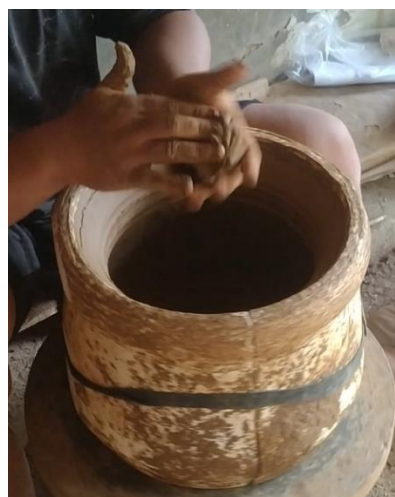
Gambar 10. Proses menyatukan cetakan menggunakan karet Sumber: Dokumentasi Penulis
